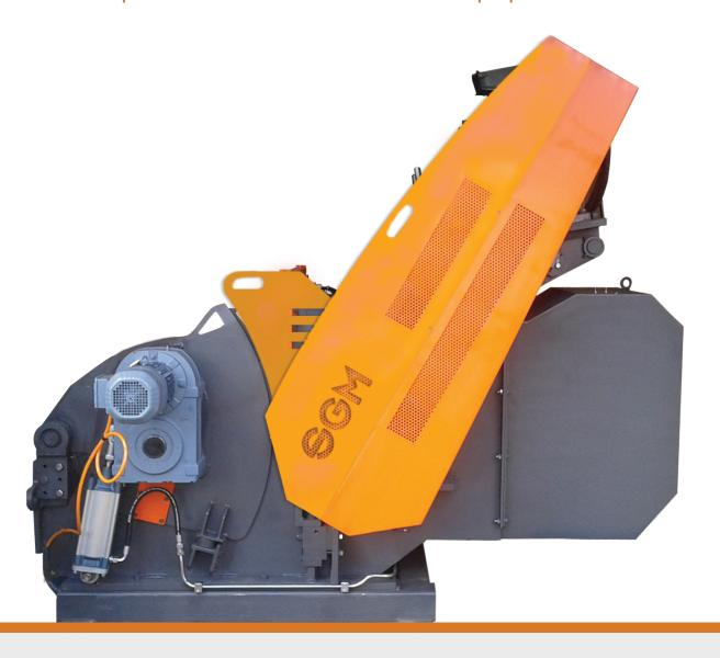
Ces déchiqueteuses sont destinées à transformer les sous produits de sciage ou de déroulage en plaquettes de qualité papetière, à la production de panneaux ou d'énergie, ainsi qu'à la torréfaction et au paillage. SGM se concentre sur la fabrication de déchiqueteuses équipées de tambour a couteaux et de leurs péripheriques, en particulier les équipements de tamisage et de stockage.
